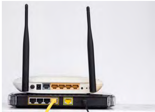
Router, Rückseite, Blick auf die RJ-Anschlüsse und einige Tasten
