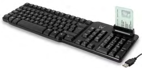
Tastatur, die einen Kartenleser enthält. Die Karte enthält einen Chip, der unsere digitale ID speichert
